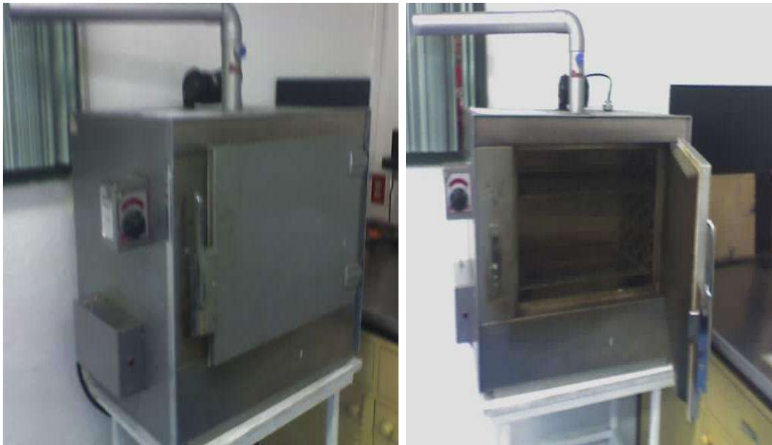
Figura 3. Calentamiento de las muestras de barniz en el horno RIOSSA Modelo HOF-40.
