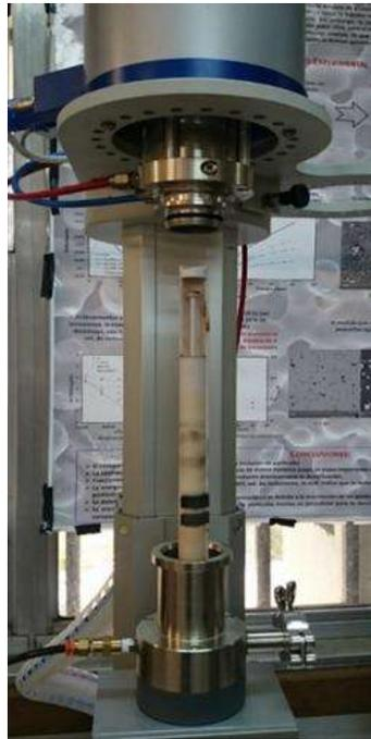
Fig. 5.1 Dilatómetro vertical Linseis L75V.
