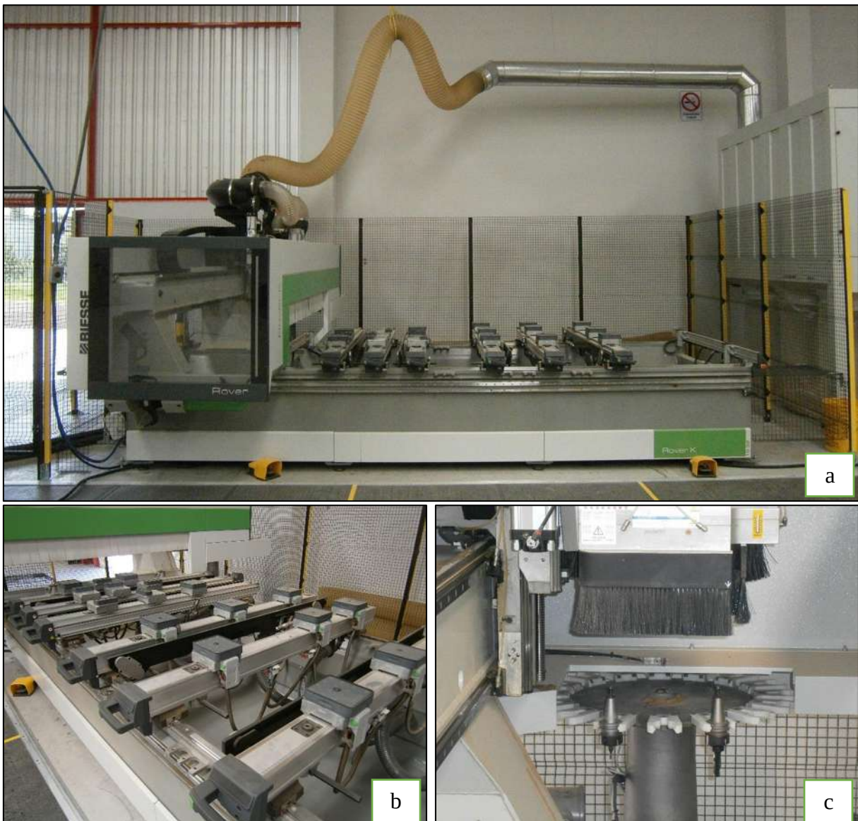
Figura 29 Reuter CNC Biesse Rover K 1532, a) vista frontal, b) ventosas de sujeción, c) cabezal para herramientas.
