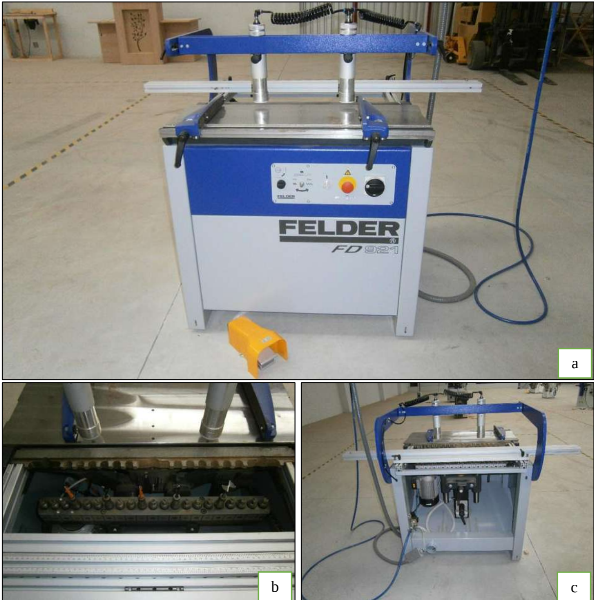
Figura 25 Taladro múltiple Felder FD 921, a) vista frontal, b) cabezal porta herramientas, c) vista posterior.
