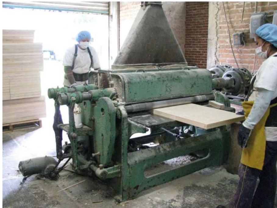
Figura 10. Acabado superficial del tablero.
