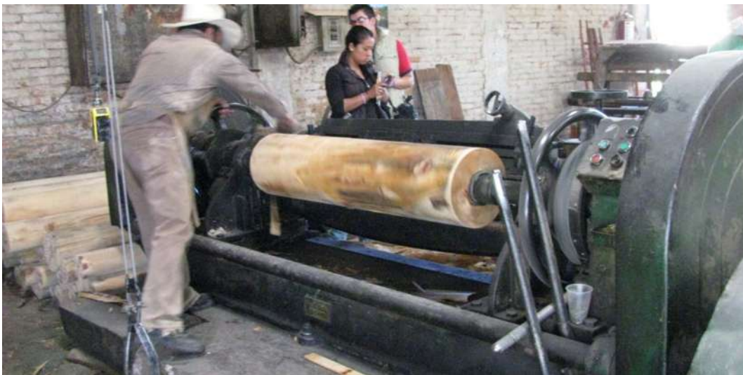
Figura 4. Torno de desenrollo o desenrolladora.
