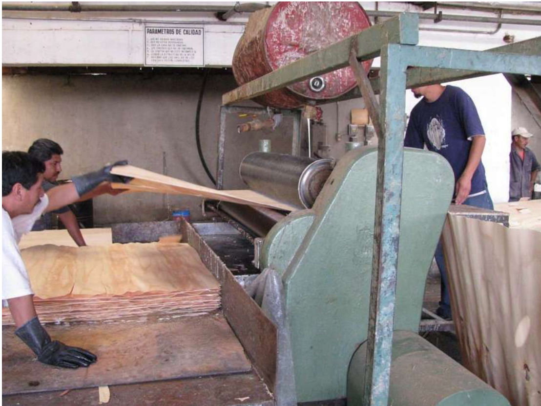
Figura 8. Encolado de chapas o engomado.
