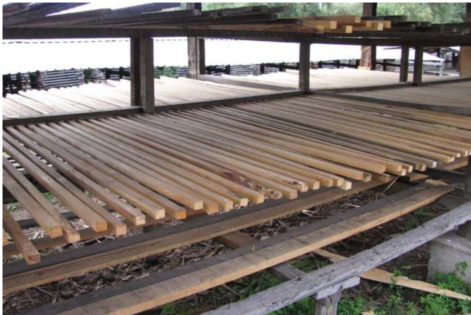
Figura 11. Listones en secado al aire.
