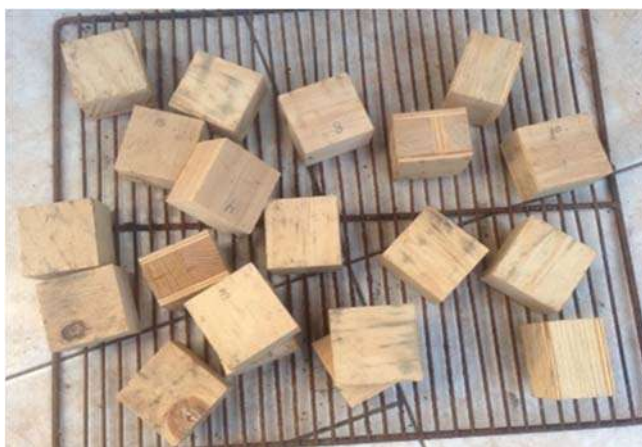
Figura 15. Probetas para la determinación de la delaminación de las chapas.
