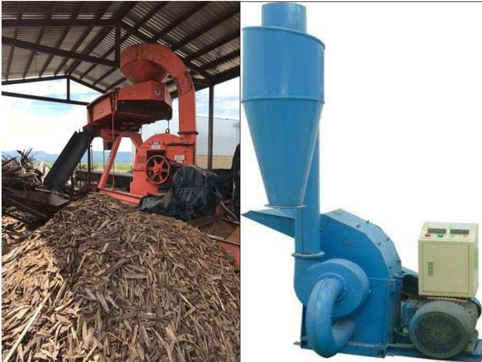
**Figura 20.** Astilladora (Morbark) y molino de tornillos (BFSC-A DE AGICO).
