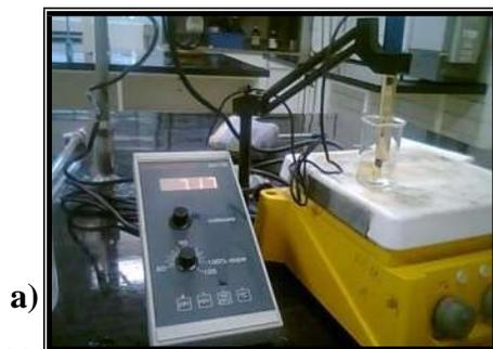
**Figura 11.** a) Medición de pH con potenciómetro.
