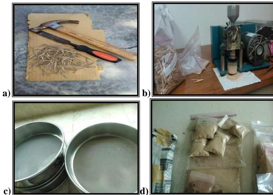
**Figura 8.** Proceso para habilitación de material, a) Astillado, b) Molienda, c) Tamizado, d) clasificación de harinas.
