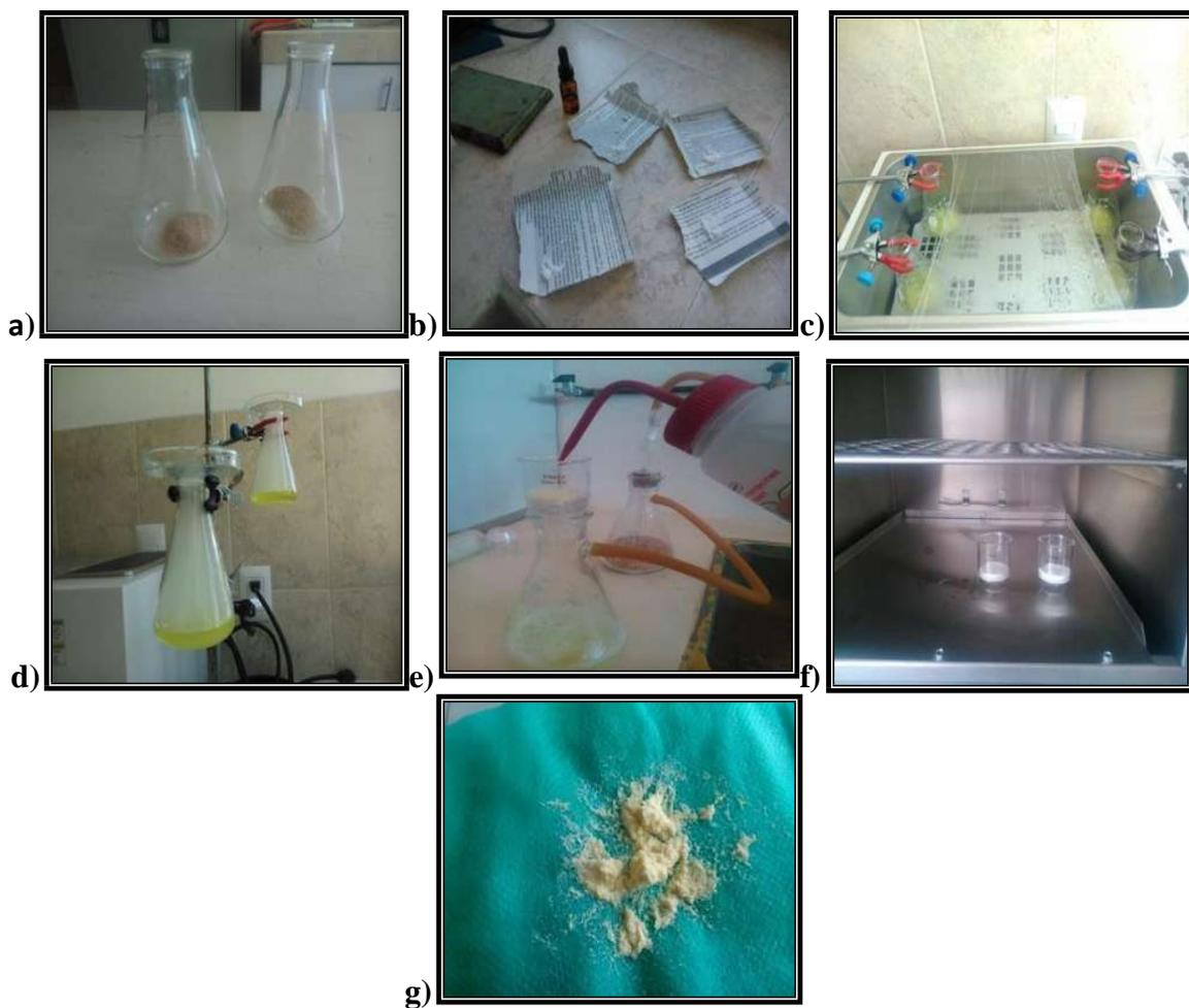
**Figura 16.** Proceso para obtención de holocelulosa, a) Muestra, b) Clorito de sodio y ácido acético, c) Baño María, d) Agitación, e) Filtrado y lavado mediante vacío, f) Secado a peso constante, g) Holocelulosa.
