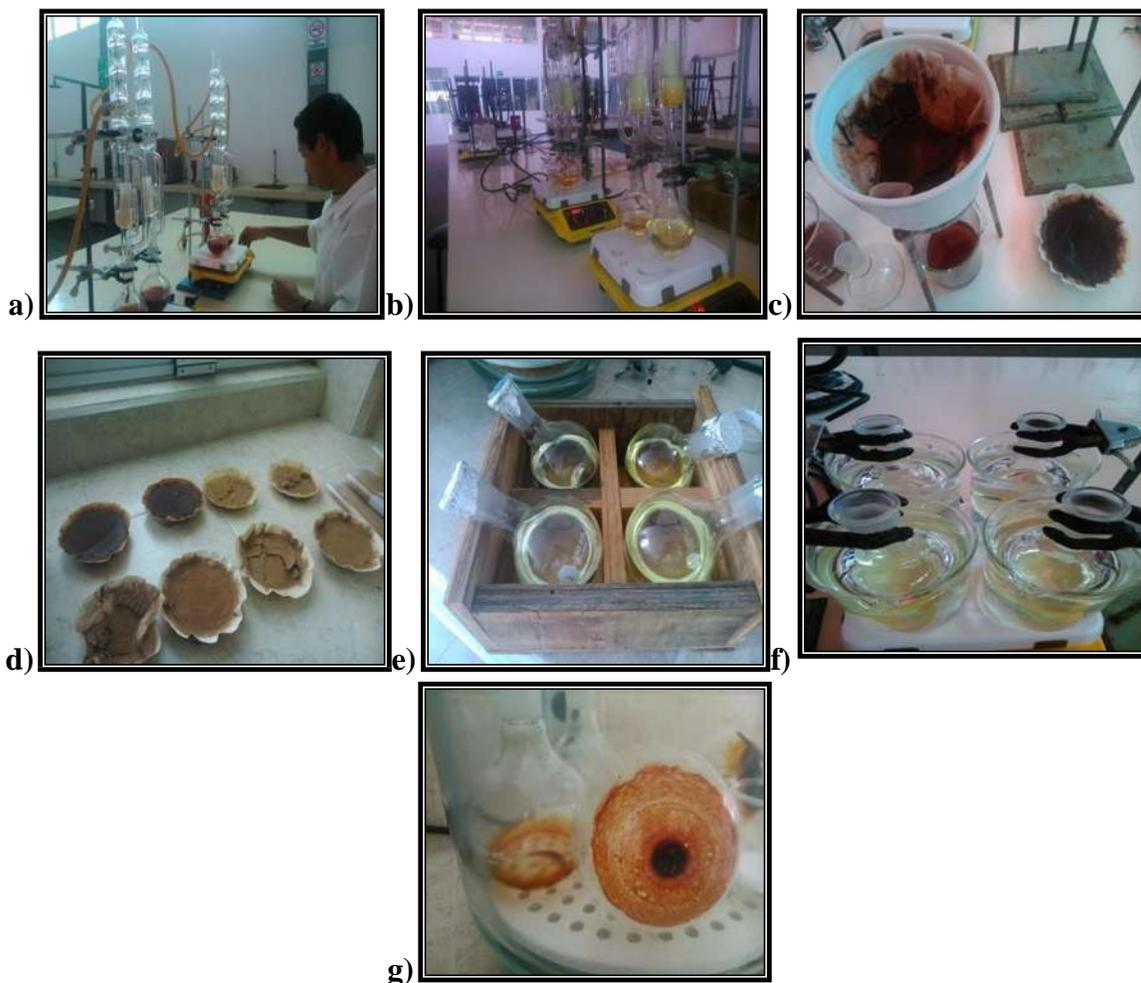
**Figura 14.** Secuencia para la extracción Soxhlet, a) Equipo Soxhlet, b) Extracción con solventes, c) Filtrado, d) Harina libre de extraíbles, e) Extractos en solución, f) Evaporación de solvente, g) Extractos.
