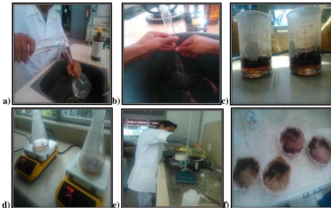
**Figura 15.** Secuencia para determinar el contenido de lignina, a) Preparación de ácido sulfúrico al 72 %, b) Preparación de ácido bromhídrico al 40 %, c) Muestra en solución, d) Ebullición de muestras y solución, e) Filtrado y lavado, f) Lignina anhidra.
