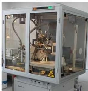
**Figura 7.** Difractómetro de rayos X Bruker
