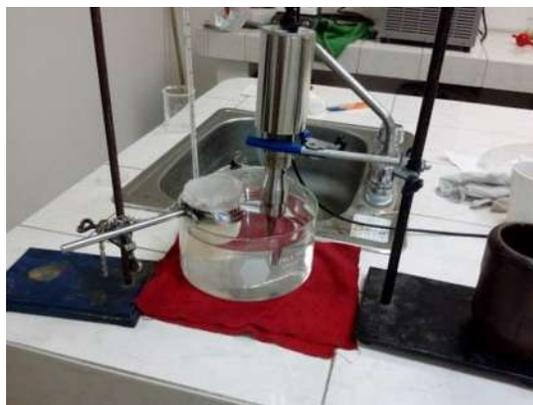
**Figura 2.** Proceso de sonicación.
