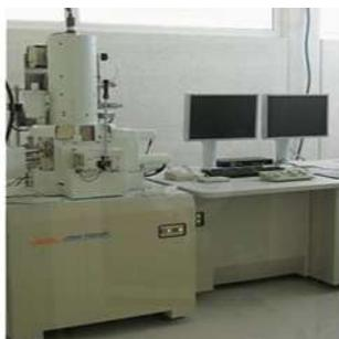
**Figura 5.** Microscopio de emisión de campo JEOL JSM-7600
