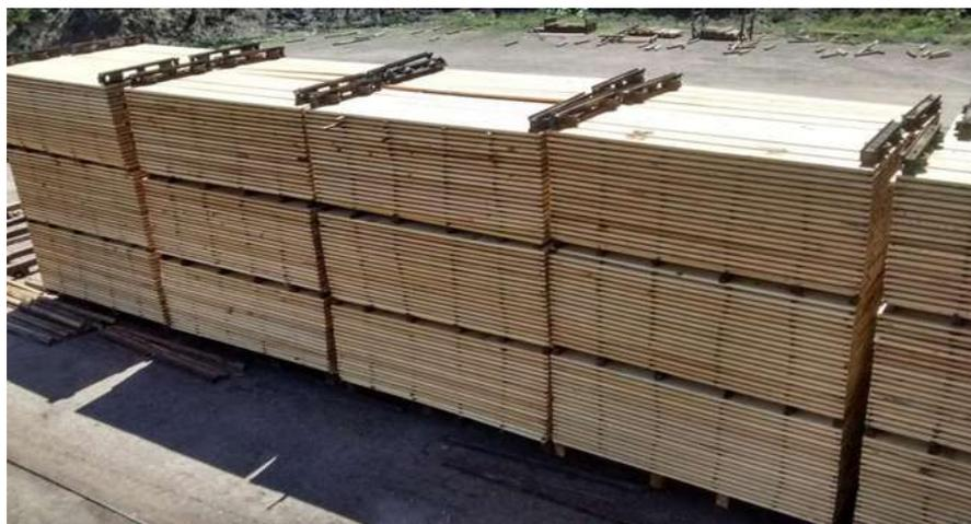
*Figura 21. Carga de madera preparada con sobrepesos en la parte superior de cada paquete.*
