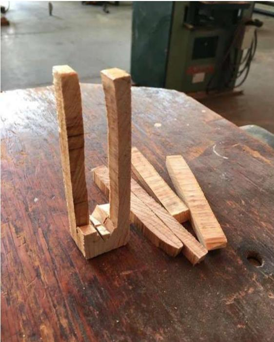
Figura 28. Probeta de tenedor elaborada con madera de pino, presentando un poco de endurecimiento.
