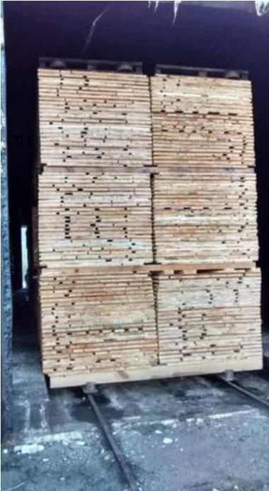
*Figura 23. Estufa cargada antes de iniciar el secado, se aprecian los carritos, polines de apoyo, fajillas, contrapesos*
