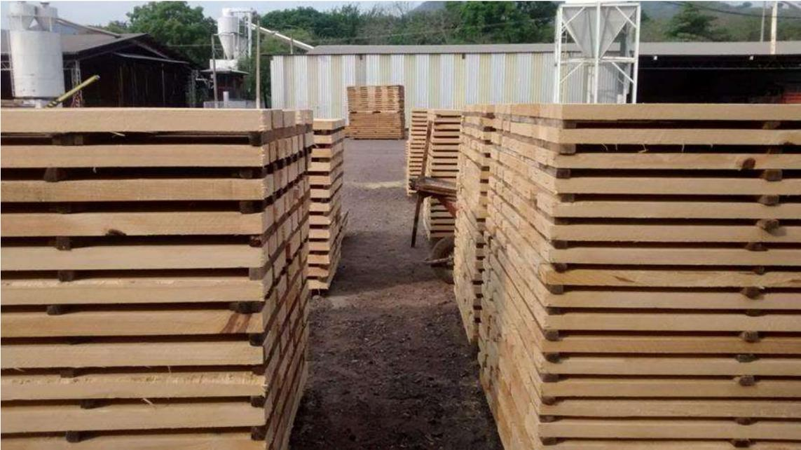
*Figura 18. Clasificación por grosor de la madera a estufar.*
