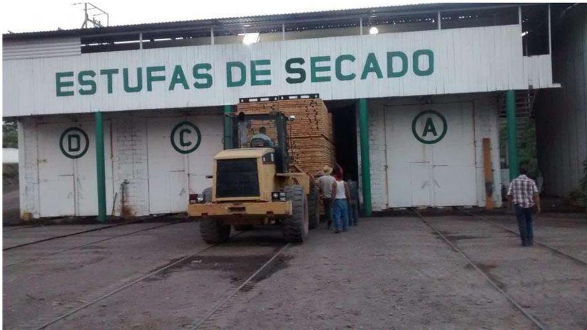
*Figura 22. Introducción de la carga por medio de carritos empujados por el montacargas para facilitar el llenado de la estufa.*
