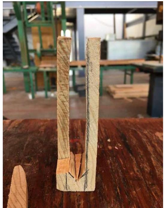
Figura 29. Probeta elaborada en una tabla de madera de 3/4, la cual presenta endurecimiento.
