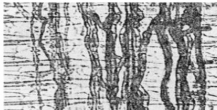
Figura 12. Corte radial de un PINO afectado por la mancha azul.
