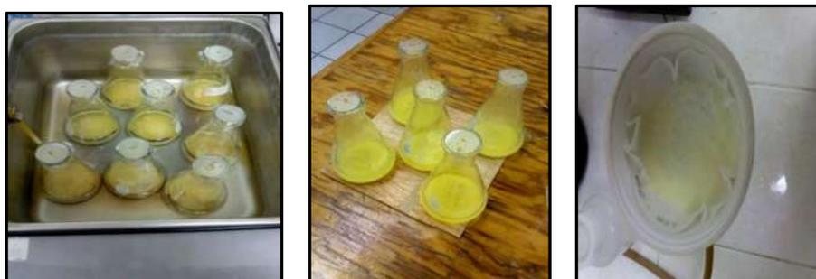
**Figura 13.** Determinación del porcentaje de Holocelulosa.
