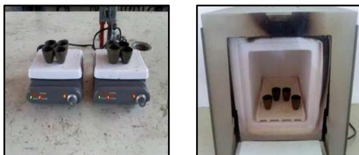
**Figura 8.** Determinación de cenizas.
