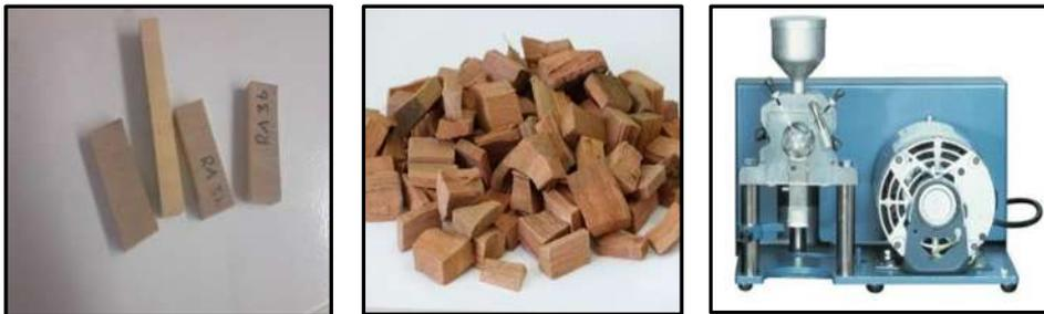
**Figura 4.** Astillado y molido de la madera.
