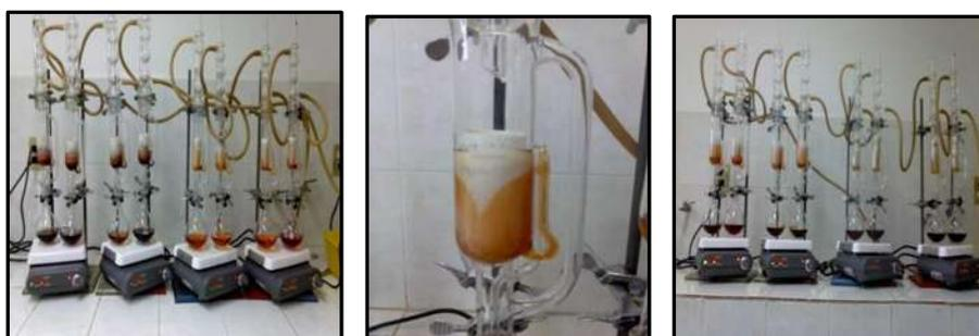
**Figura 9.** Obtención de extraíbles en equipo Soxhlet
