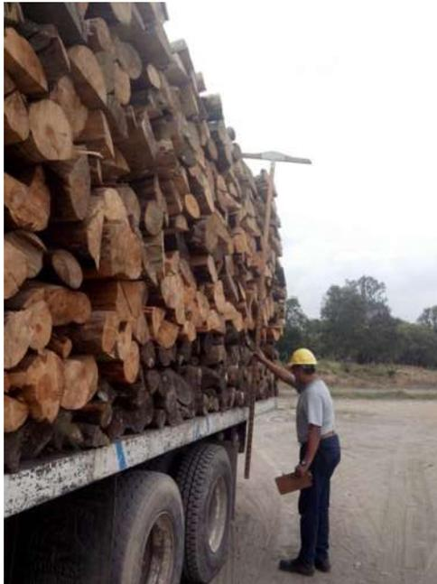
**Figura 11.** Medición de la altura de la carga en camión.
