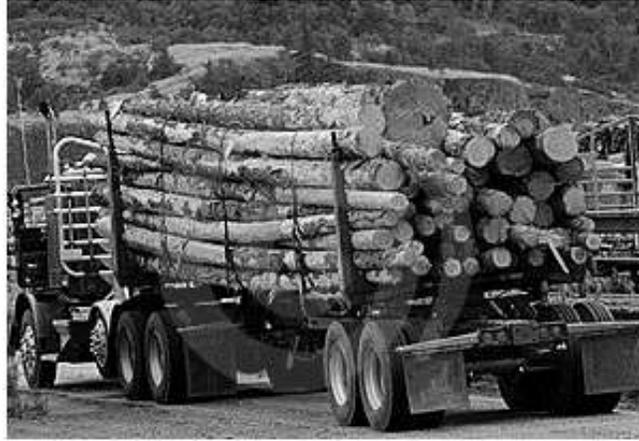
**Figura 2.** Tracto-lanza con madera en rollo.
