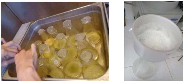
**Figura 7.** Obtención de holocelulosa. Izquierda: muestras colocadas en un baño María. Derecha: filtrado y lavado de la holocelulosa.
