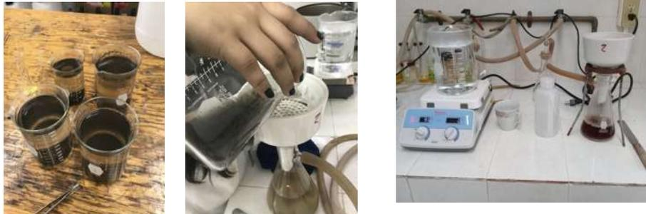
**Figura 8.** Obtención de lignina Runkel. Izquierda: reacción para la descomposición de la celulosa y hemicelulosas. Central: filtrado. Derecha: lavado con agua caliente.
