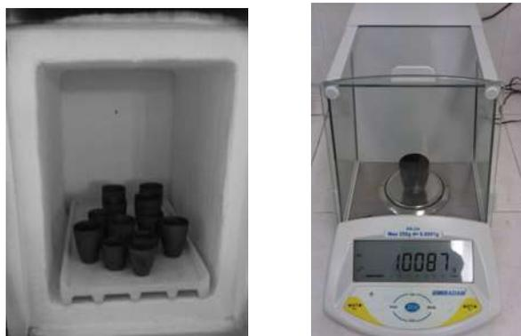
**Figura 5.** Determinación del contenido de ceniza. Izquierda: calcinación de la harina de madera a 550 °C. Derecha: obtención del peso anhidro de las cenizas.
