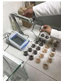
**Figura 4.** Lectura del pH con ayuda del potenciómetro. Izquierda: Potenciómetro. Derecha: lectura de pH de las muestras.
