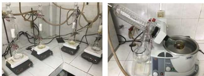
**Figura 6.** Obtención de extraíbles mediante secuencia sucesiva. Izquierda: obtención de extraíbles en equipo Soxhlet con disolventes orgánicos. Central: recuperación de los solventes en rotavapor aplicando vacío. Derecha: obtención de extraíbles con agua caliente a reflujo.
