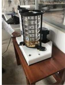
**Figura 3.** Equipo ROTAP para el tamizado de las muestras de los residuos maderables, para obtener la fracción de la malla # 40.
