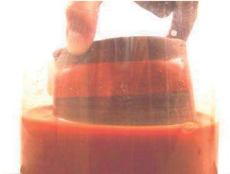
Figura 6. Reforzamiento de biscochos con una suspensión de arcilla lavada.
