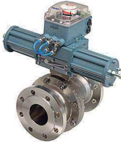
**Válvula on-off:** Este tipo de válvulas no son de control sino solamente son de paso ó corte y se instalaron antes de la válvula de control esto solo para efectos de mantenimiento y que pueden ser normalmente cerradas ó normalmente abiertas, van en las líneas de catalizadores, monómero emulsionado, alimentación y retorno de vapor y agua de enfriamiento y desfogue de la chaqueta del reactor.
