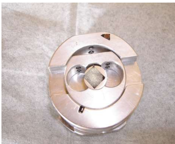
Figura 3.5. Porta muestra para MEB bajo vacío con una muestra de ^{32}\text{S} .
