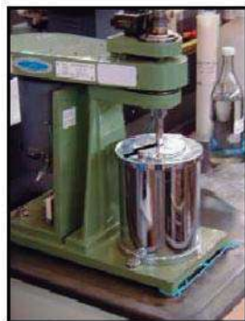
Figura 3.8. Desfibrador para hacer hojas de prueba.
