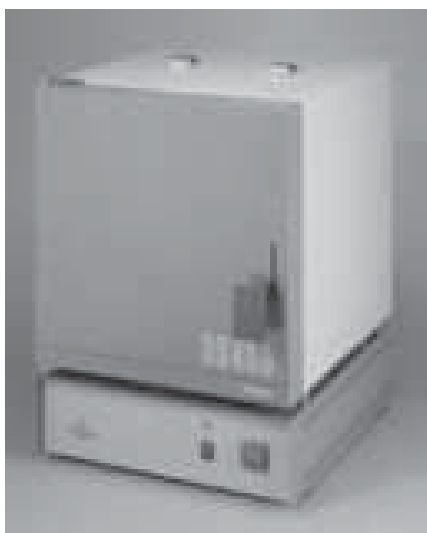
Figura 3.11. Mufla secadora de hojas.
