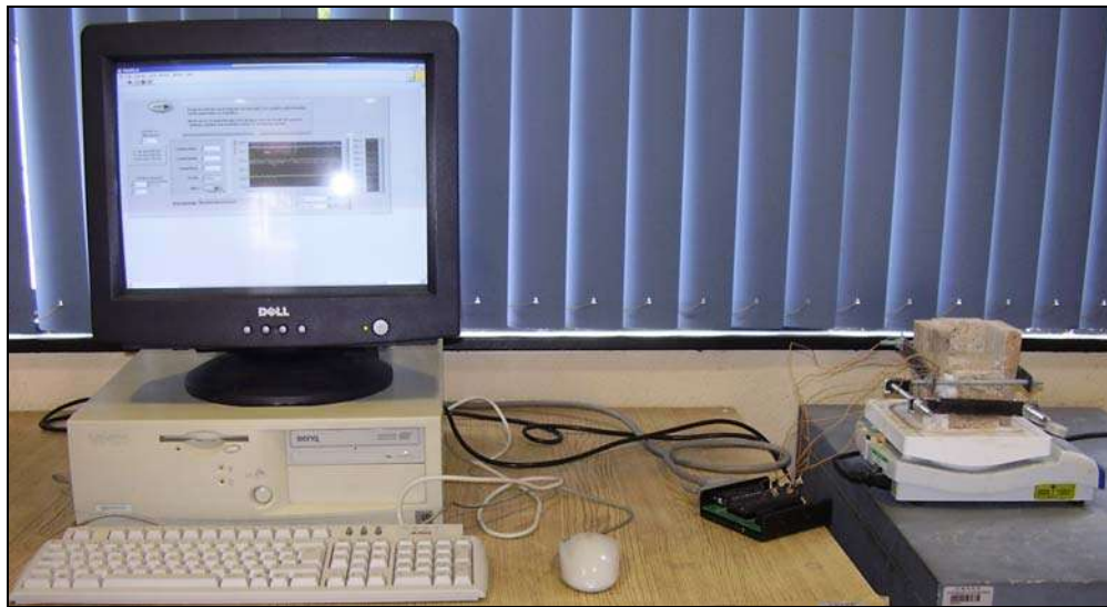
Fig. 5.9. Arreglo experimental empleado para obtener la conductividad térmica de las esponjas metálicas fabricadas.
