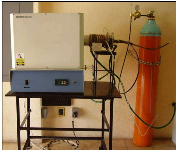
Fig. 5.3. Horno tubular horizontal Lindberg Blue con atmósfera controlada.
