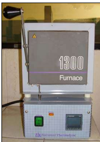
Fig. 5.6. Mufla Barnstead Thermolyne modelo 1300.
