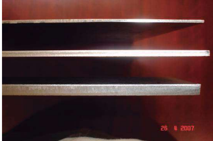
Figura 7.1. Láminas utilizadas en la experimentación de 1.6 mm, 3.2 mm y 6.4 mm de espesor respectivamente.
