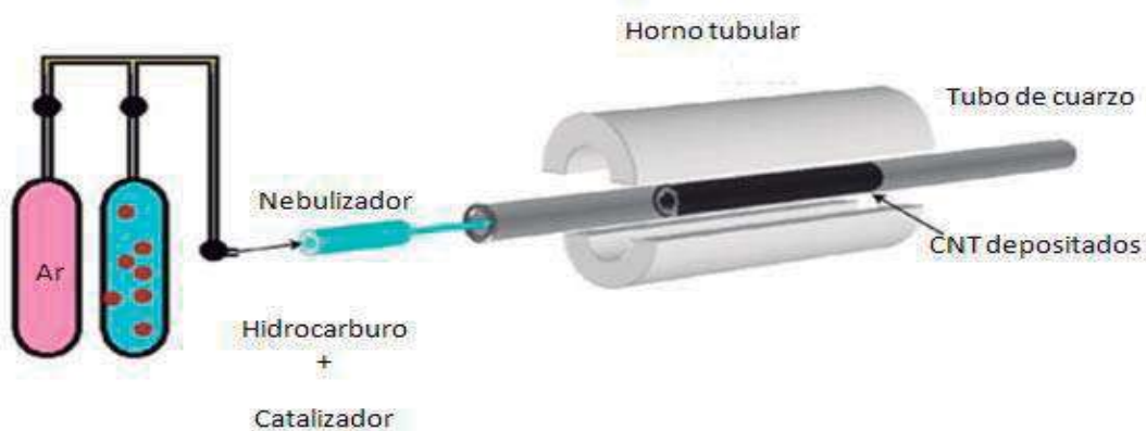
Figura 2.9 Método de síntesis de nanotubos de carbón por spray pirolisis
