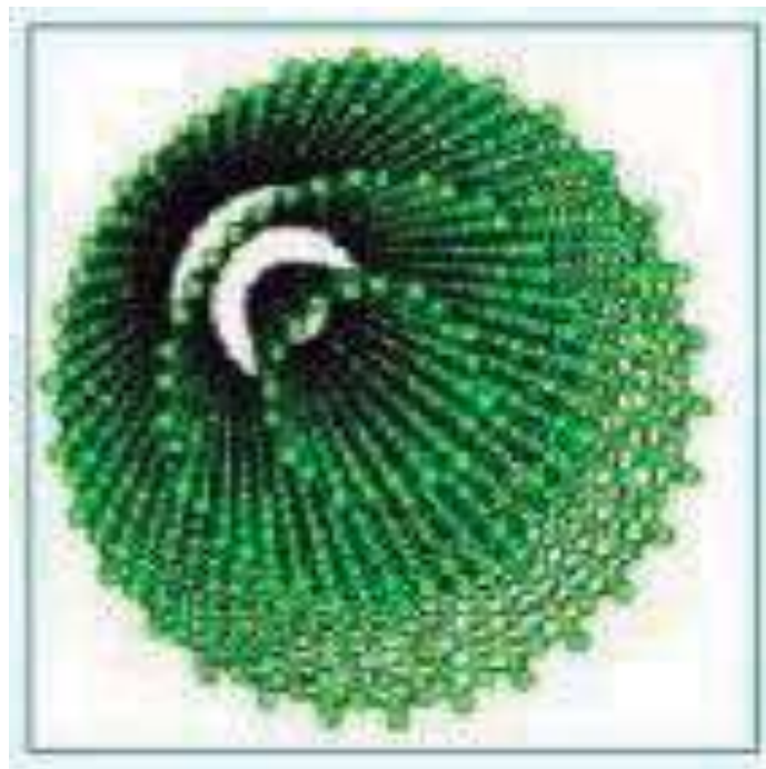
Figura. 2.3 Nanotubo de carbono de pared múltiple (MWCNT)
