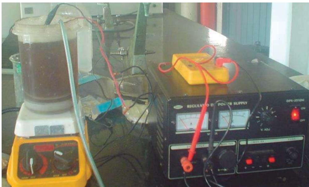
Fig. 7. Equipo utilizado para la electrogeneración del reactivo de Fenton
