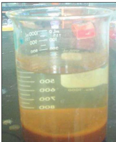
**Fig. 27.** Electro-generación del reactivo de Fenton con 4V.
