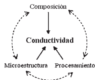
Figura 2.10. La correlación de la composición, microestructura, procesamiento, y conductividad eléctrica en materiales policristalinos bajo temperatura y atmósfera circundante dados.
