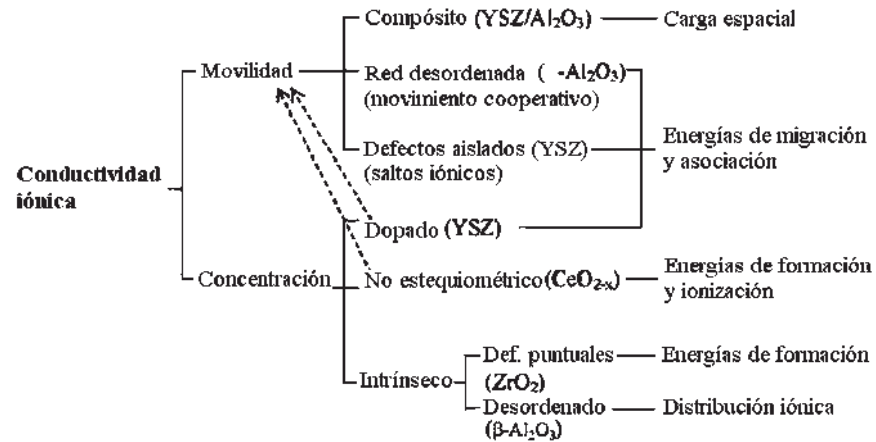
Figura 2.9. Las principales fuentes de portadores iónicos en óxidos y sus respectivas movilidades compiladas de la literatura [27].
