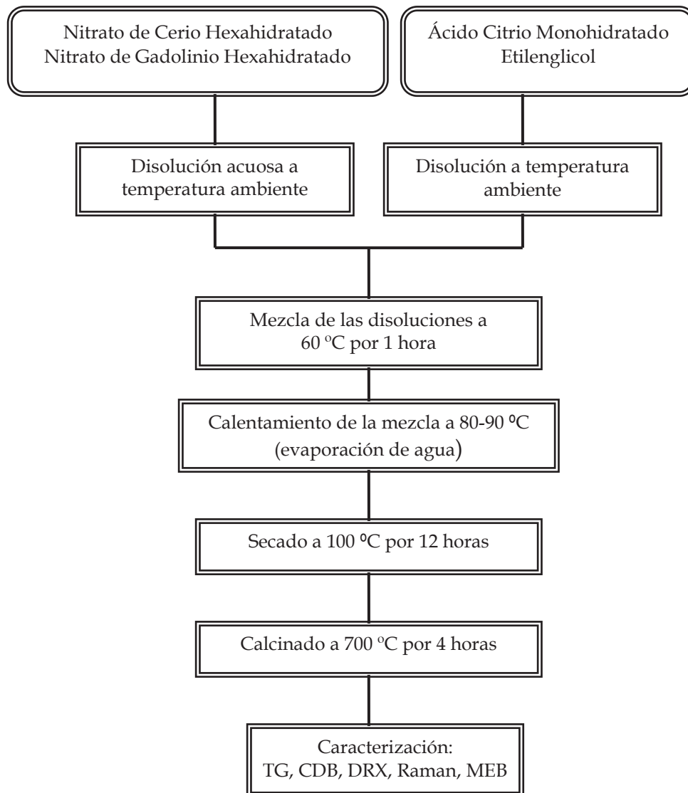
Figura 4.1. Procedimiento Experimental para la obtención de Ce_{1-x}Gd_xO_{2-x/2}
