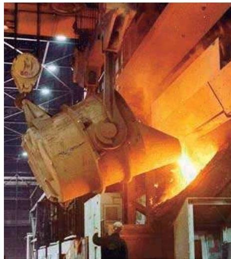
Fig. 5 Cargado de arrabio
