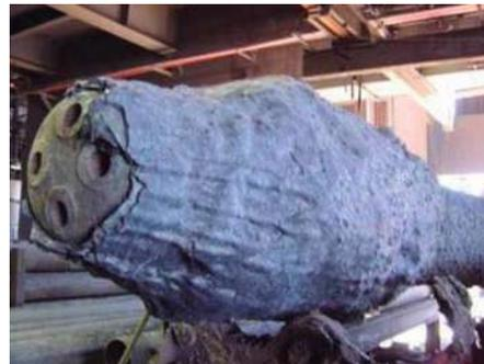
Fig. 12 Severa proyección metálica sobre la lanza.
