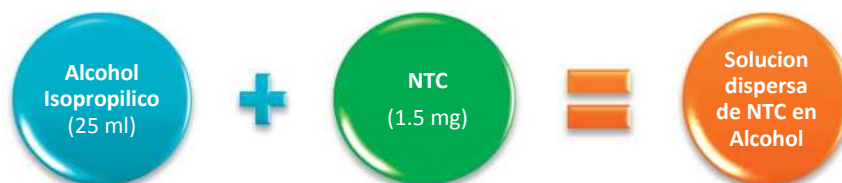
Fig. 12-b. Preparación de la solución NTC/Alcohol Isopropílico.
