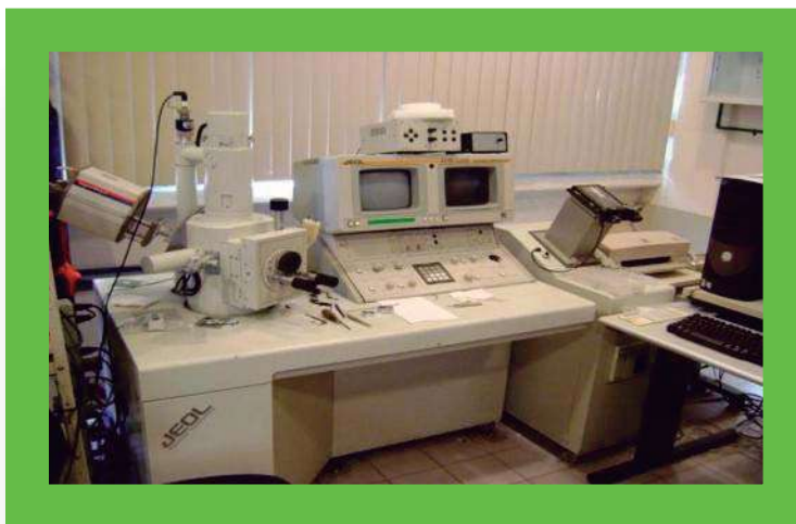
Fig.26. MEB utilizado para análisis de los catalizadores.
