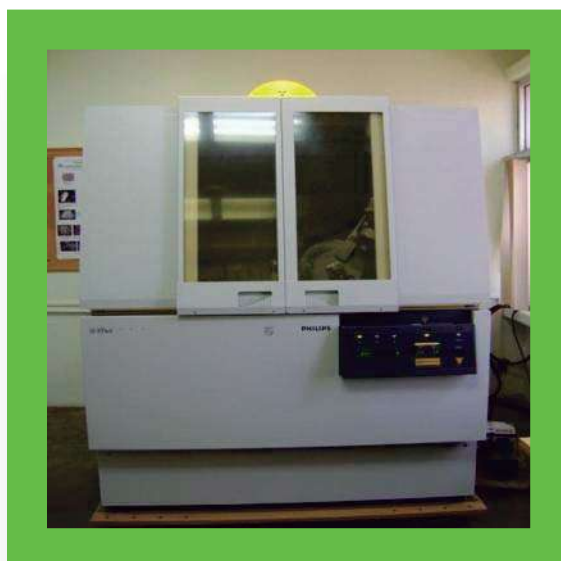
Fig. 34. Difractometro Philips Xpert. Analizador de morfología del material.
