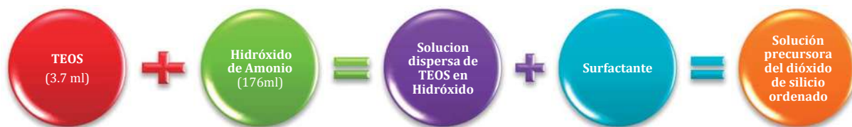
Fig. 12-a. Preparación de la solución precursora del \text{SiO}_2 .
