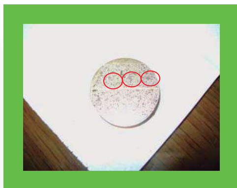
Fig. 27. Muestras introducidas a la cámara de vacío del MEB.
