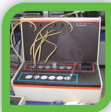
Fig. 22. Degasificador para pretratamiento térmico FlowPrep 060.
