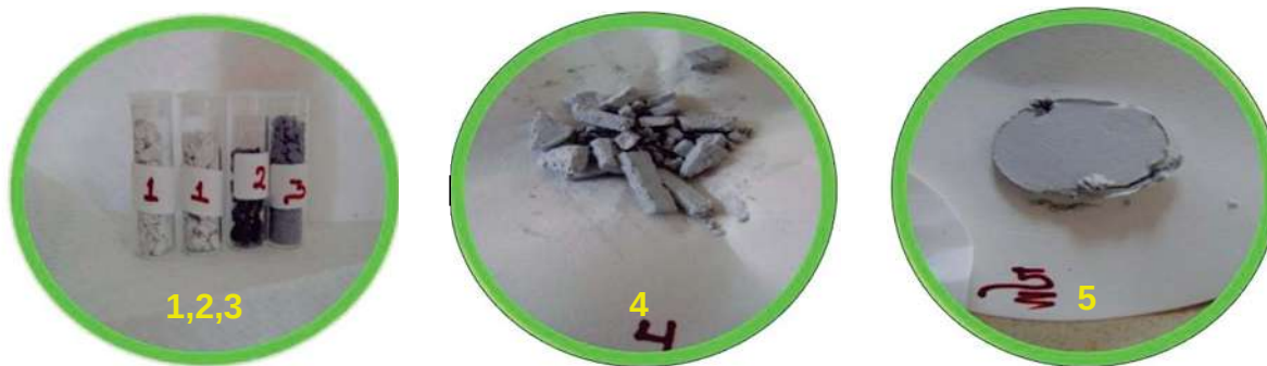
Fig. 35. Aspecto y coloración de los materiales sintetizados utilizando surfactantes, 1. CETAB, 2. Tetrapentilamonio bromuro, 3. Tetrahexilamonio bromuro, 4. Tetraheptilamonio bromuro, 5. Tetraoctilamonio bromuro.
