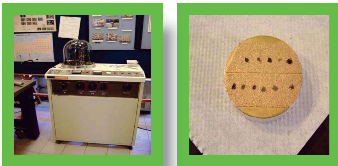
Fig. 28. Cámara de evaporación por efecto Joule. Recubrimiento con oro sobre el material que se encuentra en el porta-muestras.
