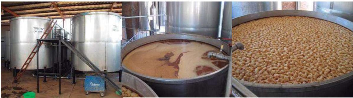
**Figura 9.** Tanques de fermentación para el jugo obtenido.
