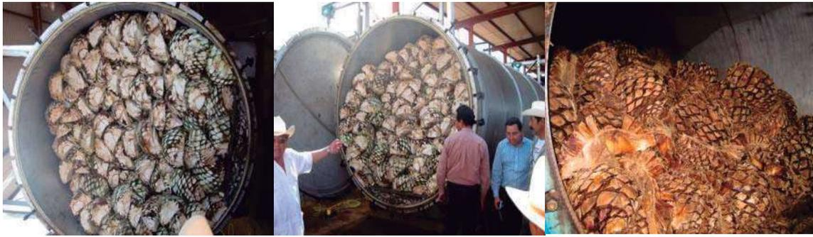
**Figura 7.** Cocción de las piñas en autoclaves.
