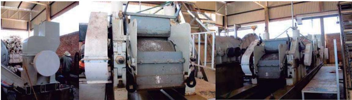
**Figura 8.** Desgarradora para piñas de agave.
