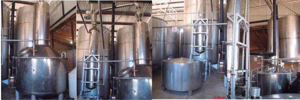
**Figura 10.** Destrozador y rectificador utilizado en la destilación.
