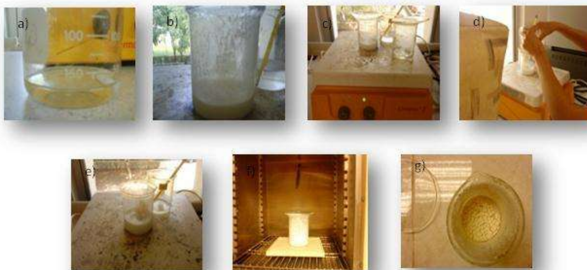
Fig. 2.2 Síntesis de \text{TiO}_2 por el método sol-Gel a) Etilenglicol, b) Isopropóxido de Titanio, c) Calentamiento Térmico de a) y b) a 60°C, d) Mezcla de a) y b) a 80°C, e) Agitación de Mezcla de a) y b), f) Evaporación en Estufa a 100°C, g) Formación de \text{TiO}_2 .
