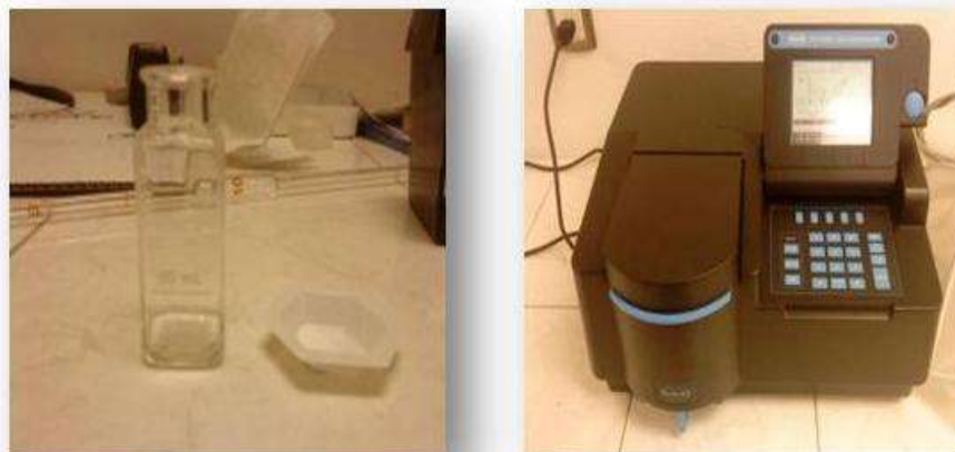
Fig. 2.9 Material y equipo utilizado para determinación de la brecha de energía
