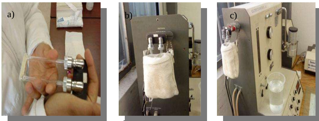
Fig. 2.8 Determinación del Área Superficial. a) Porta muestra y adaptador, b) calentador, c) equipo de medición del área superficial.
