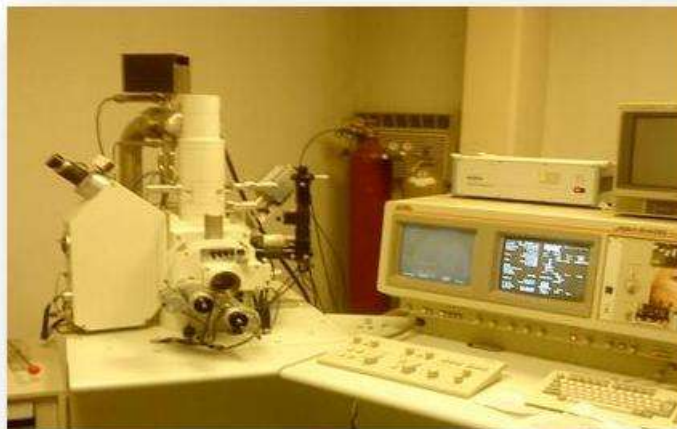
Fig. 2.4 Microscopio Electrónico de Barrido JEOL Mod.JSM-6400 con microanalizador Bruker Mod. X-Flash 4010 Instituto de Investigaciones Metalúrgicas, UMSNH.
