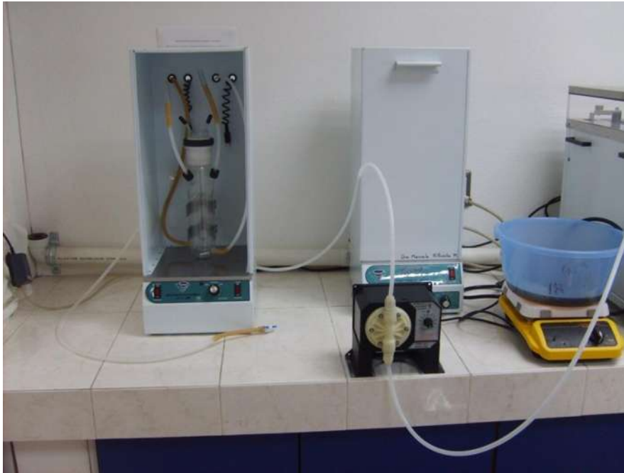
Figura 3.9 Reactor foto- catalítico continuo montado.
