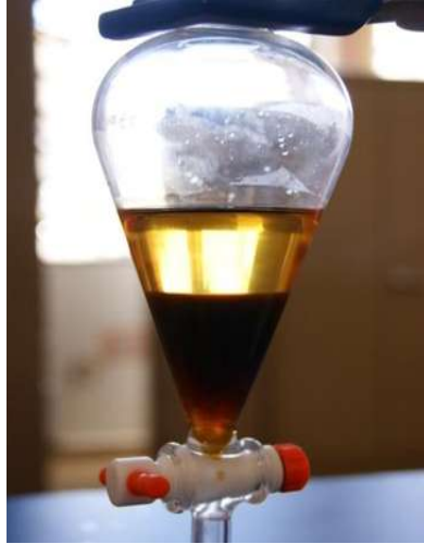
Figura 4.6 Producto final obtenido con catálisis heterogénea con zeolita HZSM-5.
