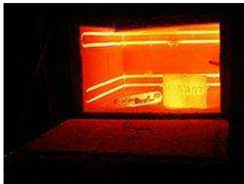
Fig. 6 Horno de recalentamiento (intermitente)
