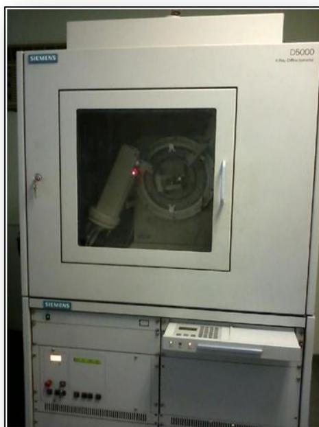
*Figura 3.10. Equipo de Difracción de Rayos X*
