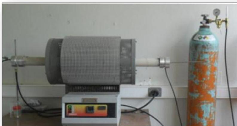
Figura 3.6. Horno de tubo horizontal con tanque de gas Ar
