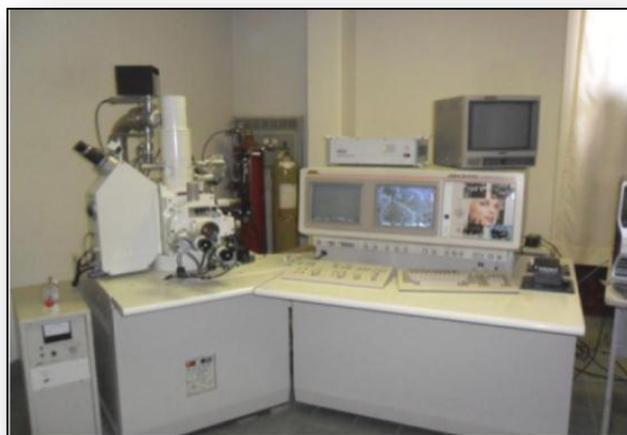
**Figura 3.11. Microscopio Electrónico de Barrido JEOL 6400**
