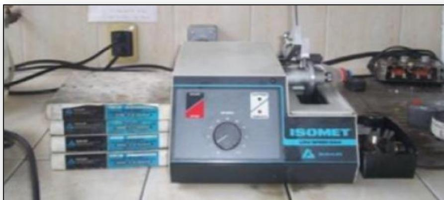
***Figura 3.8. Cortadora de precisión de disco de diamante ISOMET BUEHLER***
