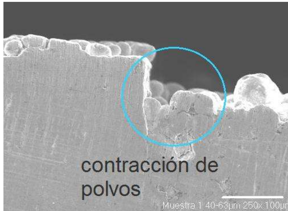
Figura.5.13c. Característica de la pieza A a 1000°C con un tamaño de polvos de 40-63µm.
