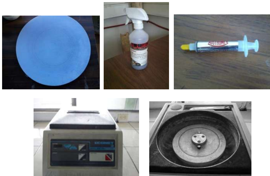
Figura.4.13.Herramientas para la preparación metalográfica de las muestras.
