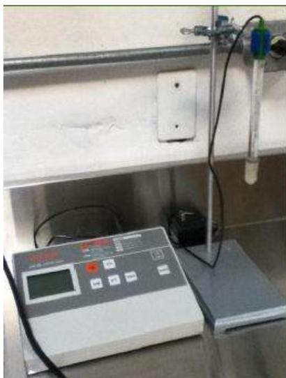
**Figura 2.** Potenciómetro marca HANNA 20V (Fuente: Trujillo, 2012).
