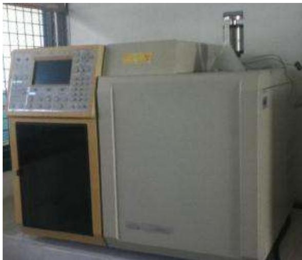
**Figura 5.** Cromatógrafo de gases marca Varian 3800. (Trujillo, 2012)
