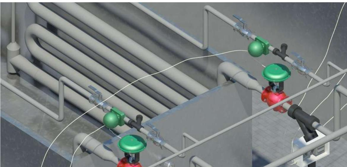
Fig. 3.20. Sistema eliminador de condensado.
