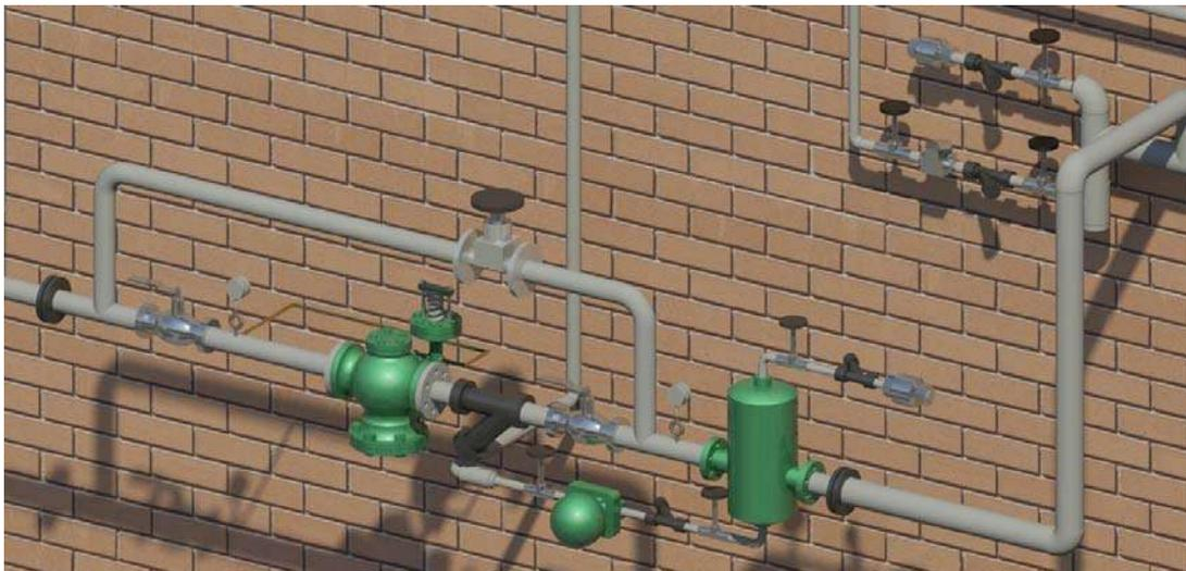
Fig. 3.18. Estación reguladora de presión completa para área de tinas de agua caliente.
