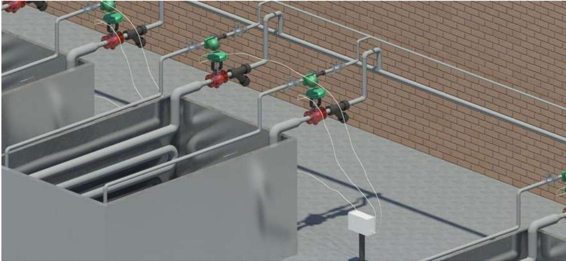
Fig. 3.19. Sistema de control de temperatura en tinas de agua caliente.
