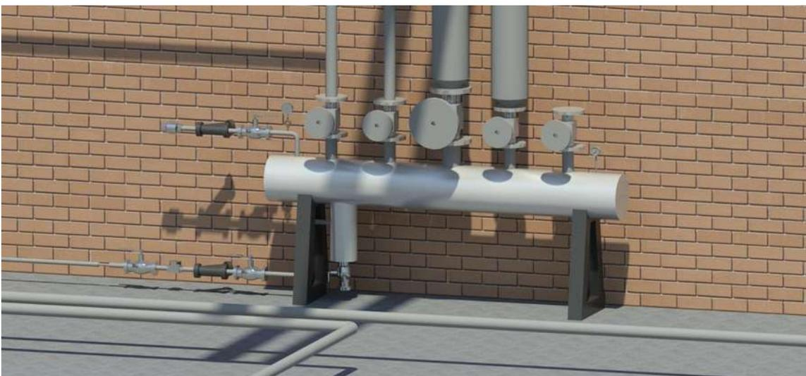
Fig. 3.10. Cabezal de distribución dimensionado correctamente.
