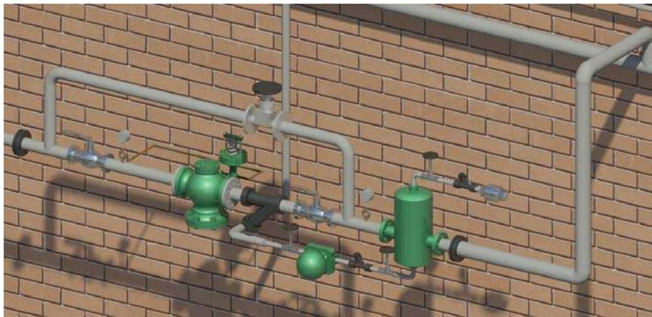
Fig. 3.24. Estación reguladora de presión completa para área de tinas de ácido.
