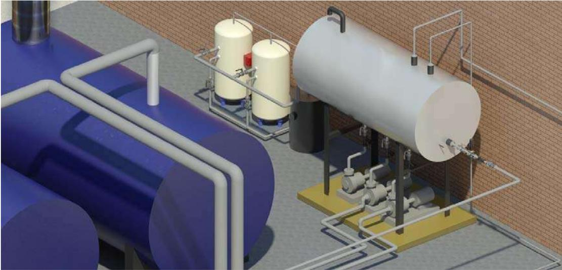
Fig. 3.12. Alimentación de agua a calderas y sistema de control de temperatura auto operante.
