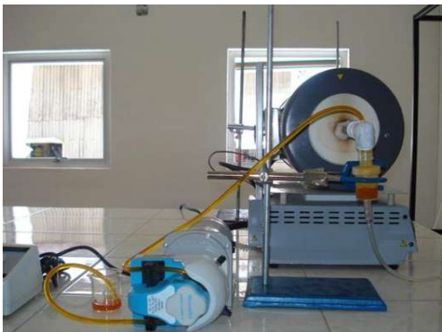
Sistema rocío pirolítico en funcionamiento
