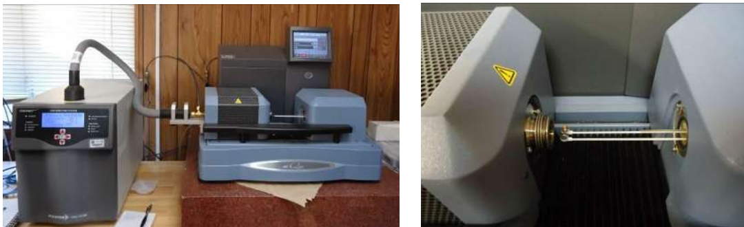
Figura 27.- TGA Instruments SDT Q600, acoplado a un PFEIFFER Vaccum Thermo Star.
