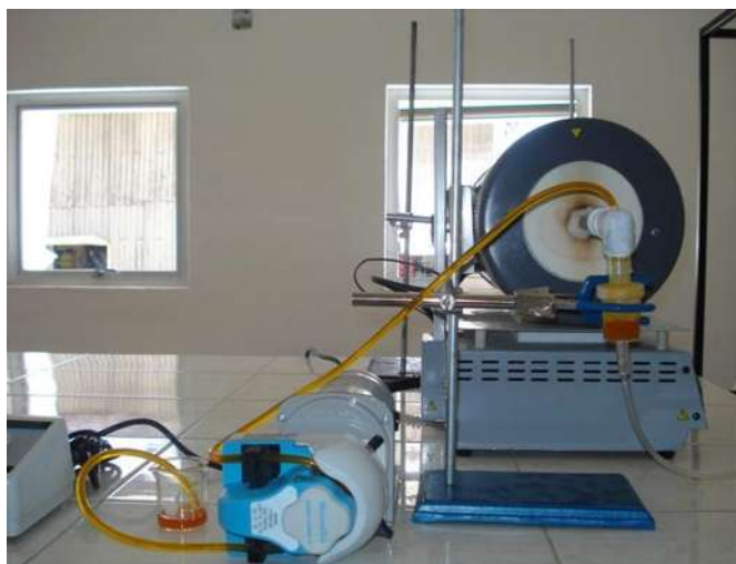
Figura 7.- Síntesis de NTC por método Spray Pirólisis
