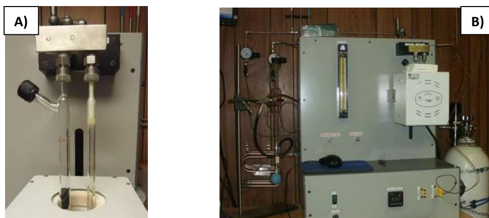
Figura 19.- Proceso de activación ex situ , de los precursores catalíticos: A) reactor tubular y B) Equipo de sulfuración
