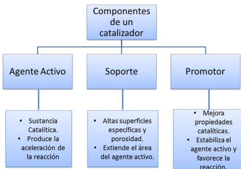
Figura 3.- Diagrama de los componentes de un catalizador y sus respectivas funciones.
