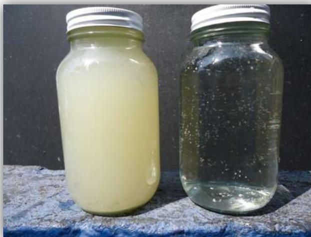
**Fig. 7** - Prueba final 1. Comparación de agua cruda (a la izquierda de la foto) y agua tratada (a la derecha de la foto).
