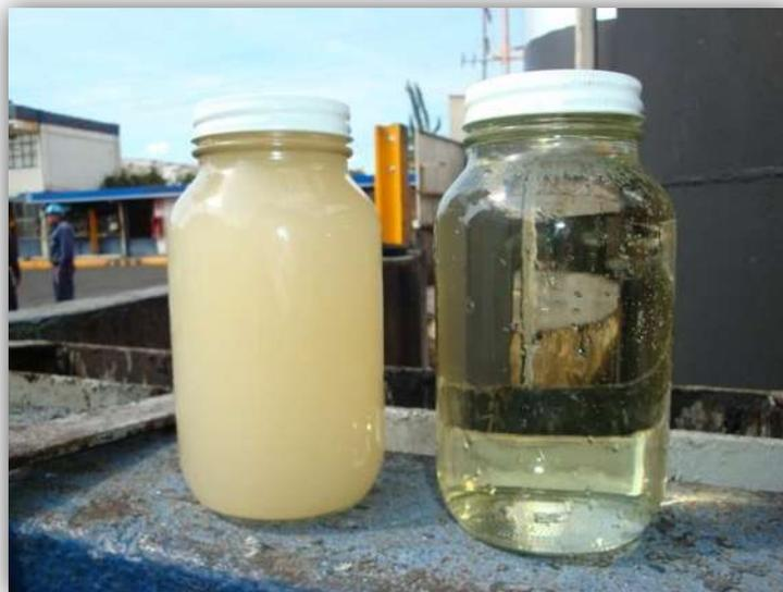
*Fig. 8 - Prueba final 2. Comparación de agua cruda (a la izquierda de la foto) y agua tratada (a la derecha de la foto).*
