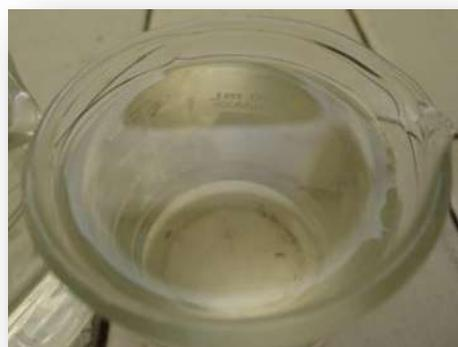
*Fig. 5 - Segunda prueba exploratoria. Prueba con cal + carbón activado + sulfato de aluminio una vez filtrada.*
