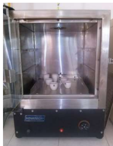
Figura 42 Prueba de humedad
