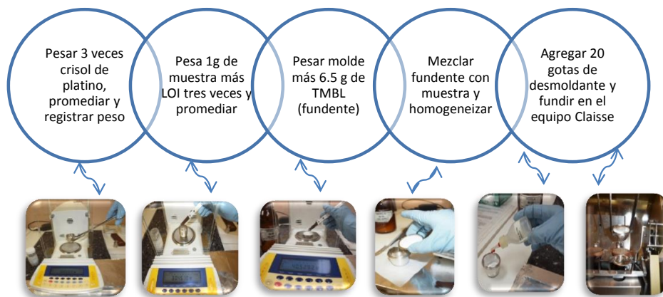
Figura IX.6. Procedimiento para fundir pastillas de MRC.
