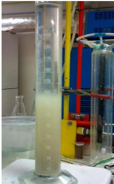
*Figura 5.8 Prueba de sedimentación al tiempo de 10 min. Se puede observar la zona de clarificación y la de espesamiento.*
