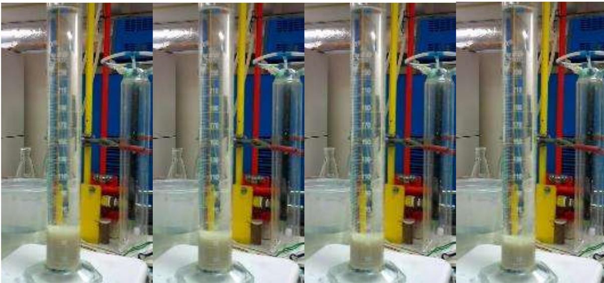
*Figura C.4 Prueba de sedimentación al transcurrir 30 min, 40 min, 50 min y 60 min.*
