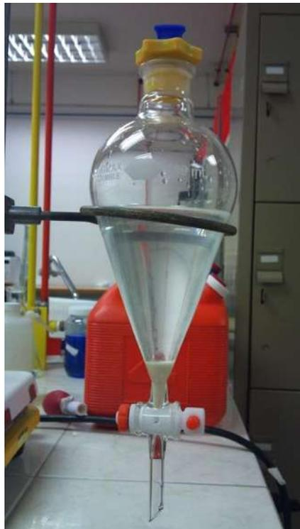
Figura 4.5 Separación de lodos por medio del embudo de separación.
