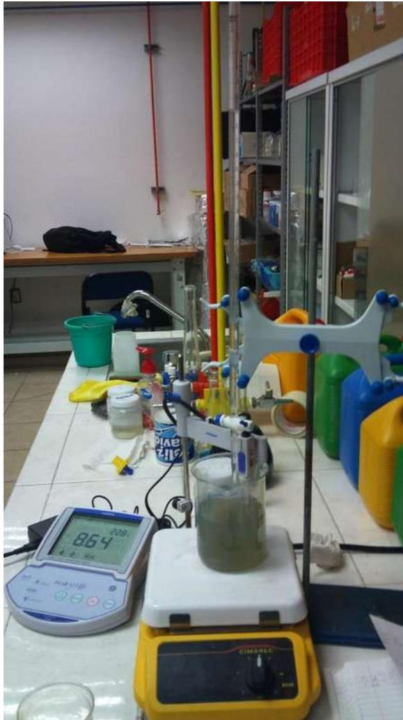
*Figura 4.2* Equipo montado para realizar las pruebas de precipitación.
