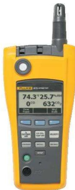
**Figura 13. Fotografía del equipo de medición Fluke 975 AirMeter.**
