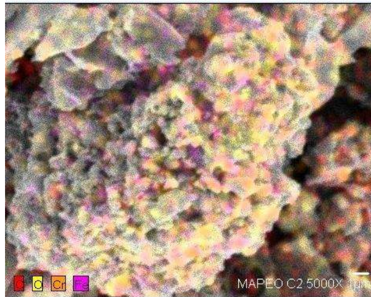
Figura 29. Mapeo a 5000X del CAQ después de tratar el agua
