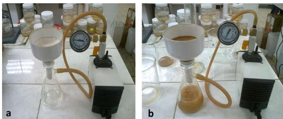
Figura 3.2 Montaje de pruebas a vacío
