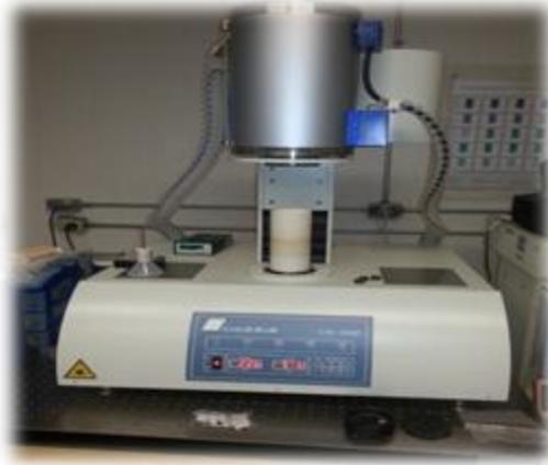
***Figura 3.11 Equipo Linseis para medir la conductividad térmica.***
