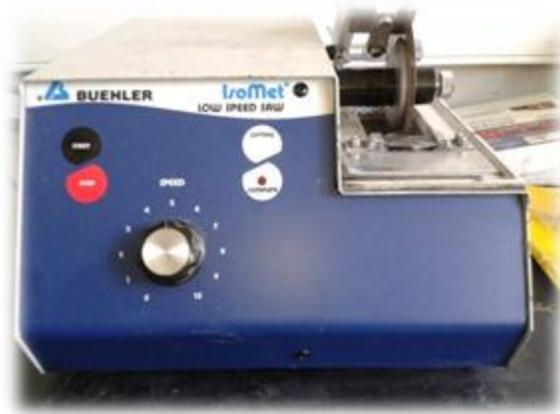
**Figura 3.3 Cortadora de diamante, de baja velocidad ISOMET.**
