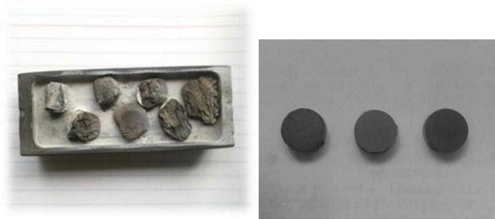
**Figura 3.7 Pastillas infiltradas a) al salir del horno, b) pulidas y sin exceso.**
