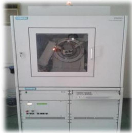
**Figura 3.9 Diffractómetro de rayos x marca SIEMENS.**
