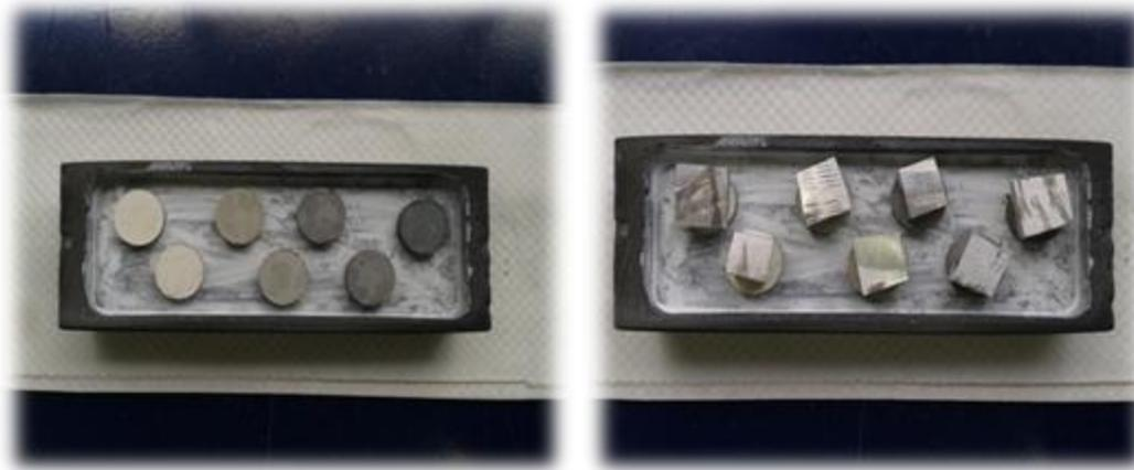
**Figura 3.4 a) Pastillas en verde sobre el crisol de grafito y b) pastillas con la aleación de Mg-AZ91E previa a la infiltración.**
