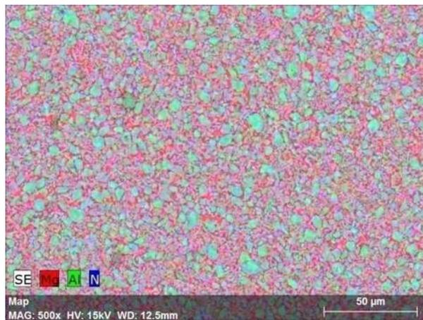
**Figura 4.21 Mapeo del compuesto AIN/Mg-AZ91E tipo C (<10 μm)**
