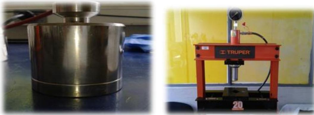
**Figura 3.2. Dado donde se hicieron las pastillas y prensa Truper usada para la compactación.**
