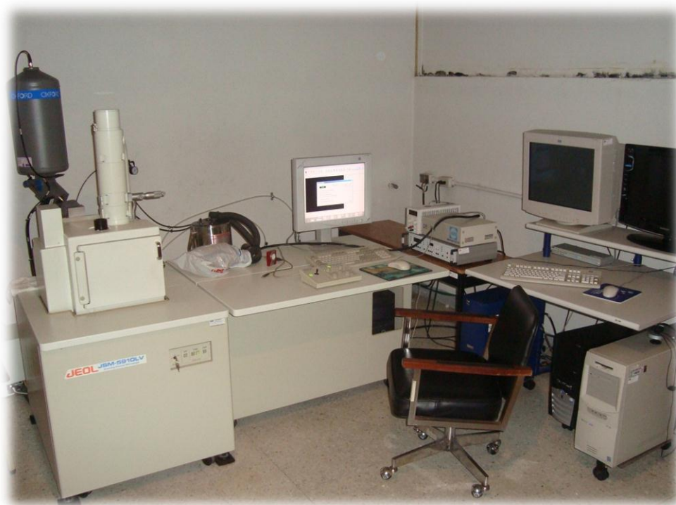
Figura 3-7 Microscopio electrónico de barrido (MEB) del posgrado de metalurgia del Instituto Tecnológico de Morelia, usado para observar y analizar el sinterizado en la parte del sustrato y los polvos.
