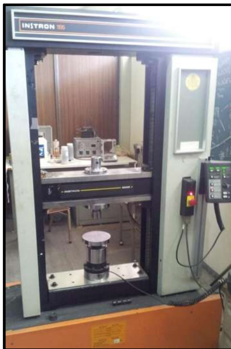
Figura 3-3. Máquina de ensayos universales Instron 1195 utilizada para la fabricación de los moldes en verde.
