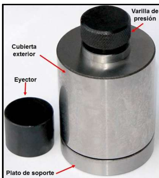
Figura 3-2. Dado utilizado en la fabricación de los compactados.
