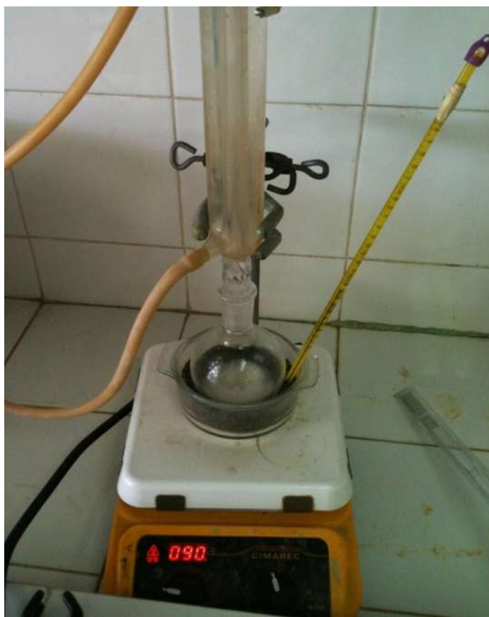
Figura 3.11. Sistema de reacción usado para la síntesis del biodiesel.
