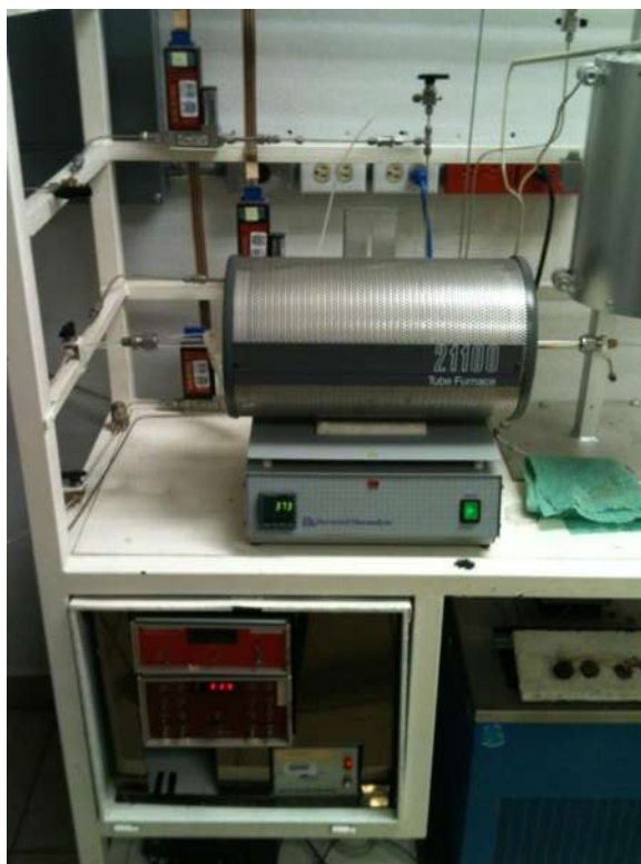
Figura 3.7 Equipo utilizado para la calcinación y activación del catalizador.
