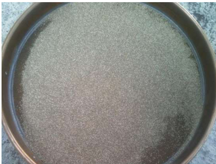
Figura 3.4 Porción de polvo entre 300-400 micras seleccionado para elaborar el catalizador.
