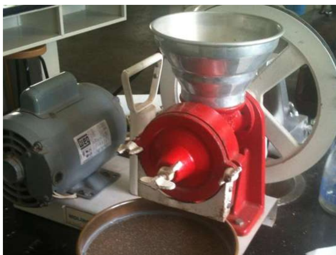
Figura 3.3 Molino de granos utilizado para pulverizar los huesos
