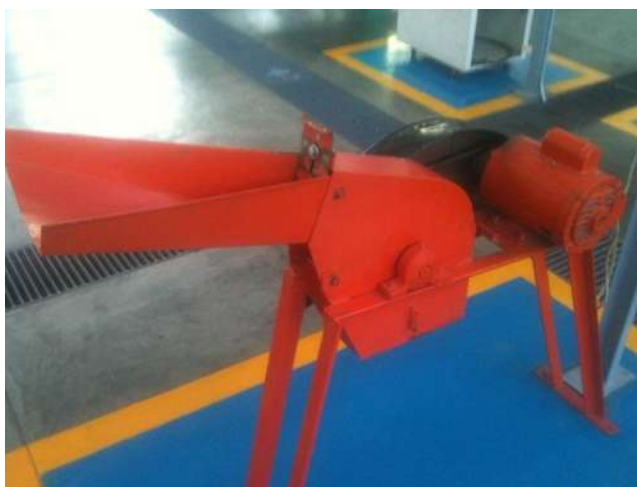
Figura 3.2 Molino de martillos utilizado para triturar los huesos.
