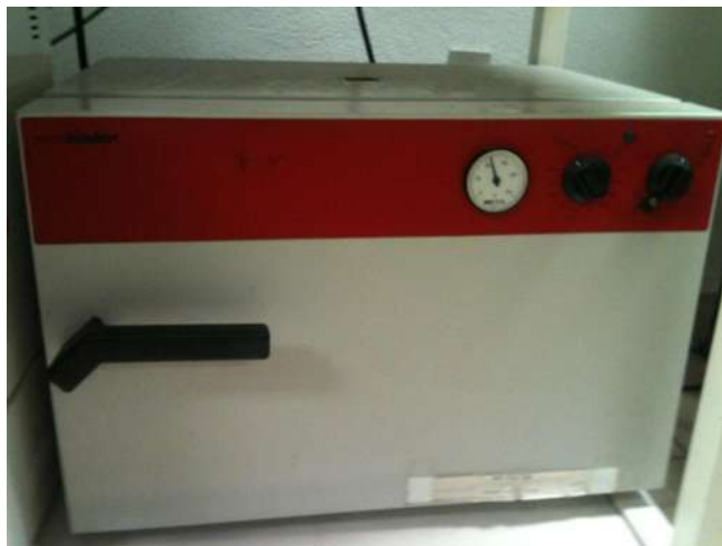
Figura 3.5 Estufa de secado de las partículas de hueso.
