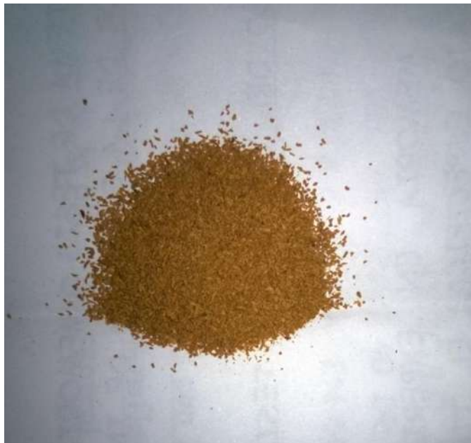
Figura 3.8. Partículas del hueso antes de la calcinación.
