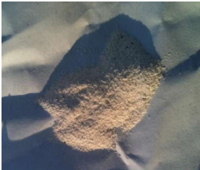
Figura 3.10. Hueso calcinado en presencia de aire.
