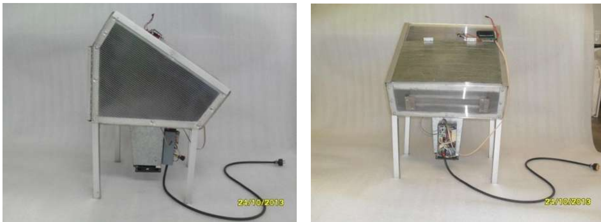
Figura 53.- Vista lateral y frontal del deshidratador de 3kg.
