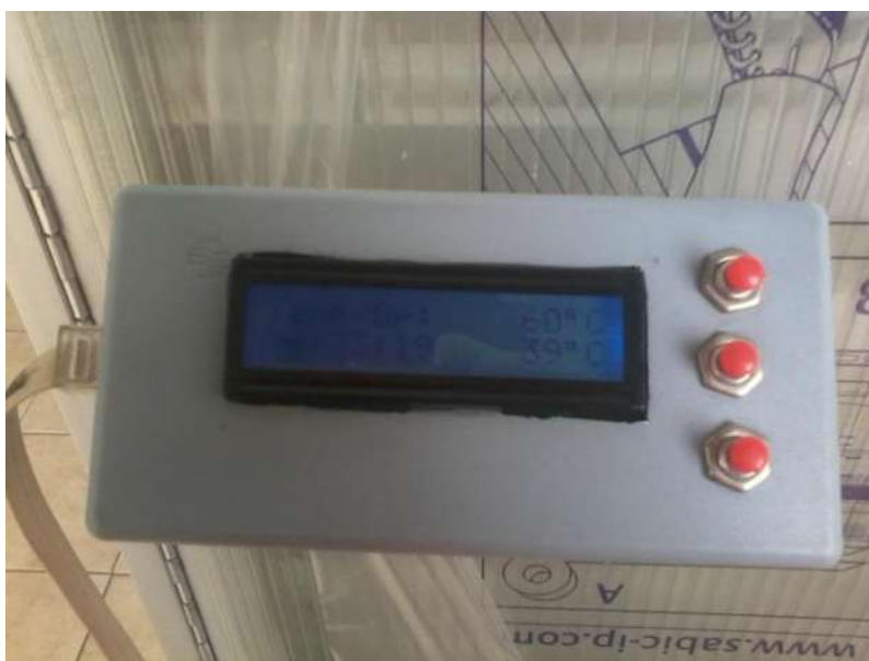
Figura 47.- Control y sensor de temperatura, el cual regula y muestra la temperatura en el interior del deshidratador.
