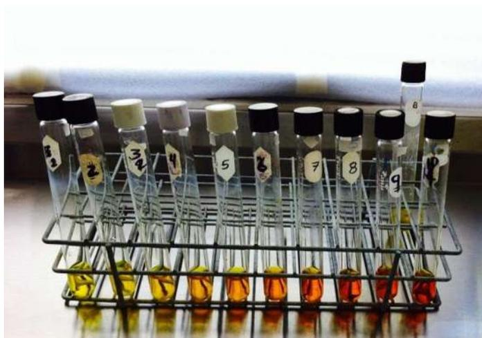
**Figura 20:** Soluciones obtenidas de la aplicación del método DNS.
