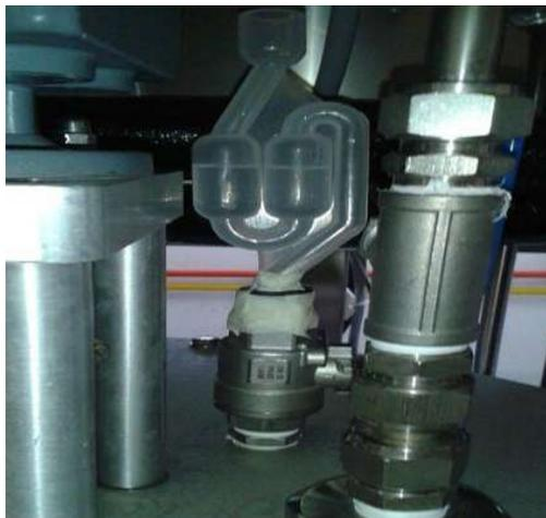
**Figura 21:** Airlock empleado para liberar el CO<sub>2</sub> producido.
