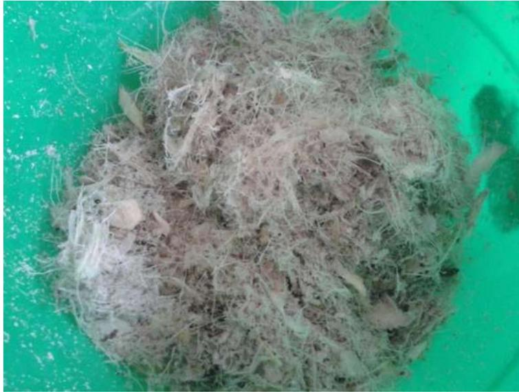
**Figura 27:** Bagazo resultante del proceso 2.
