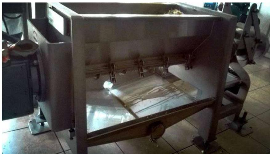
**Figura 17:** Prensa tornillo para extracción de jugos.
