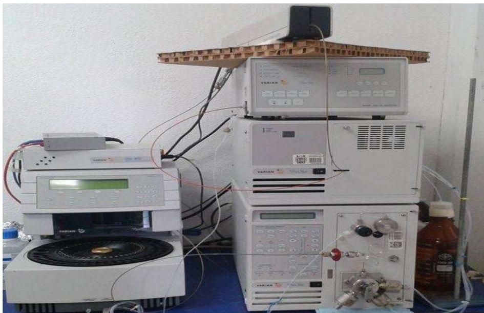
**Figura 23:** HPLC utilizado para analizar las muestras para la producción de etanol.
