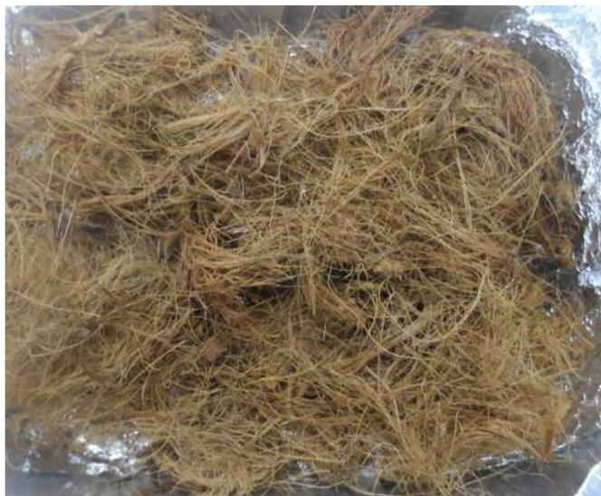
**Figura 25:** Bagazo resultante del proceso 1.
