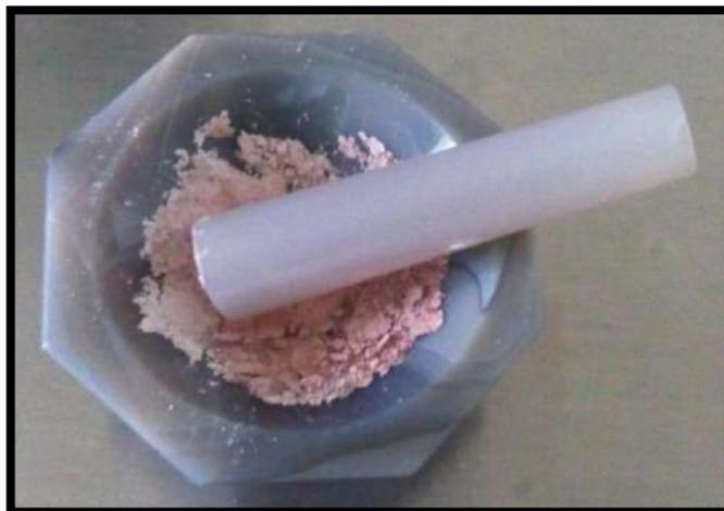
**Figura 13.** Mortero de ágata para el premezclado.
