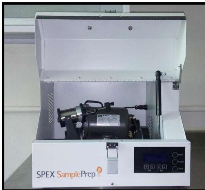
**Figura 14.** Molino vibratorio de alta energía.
