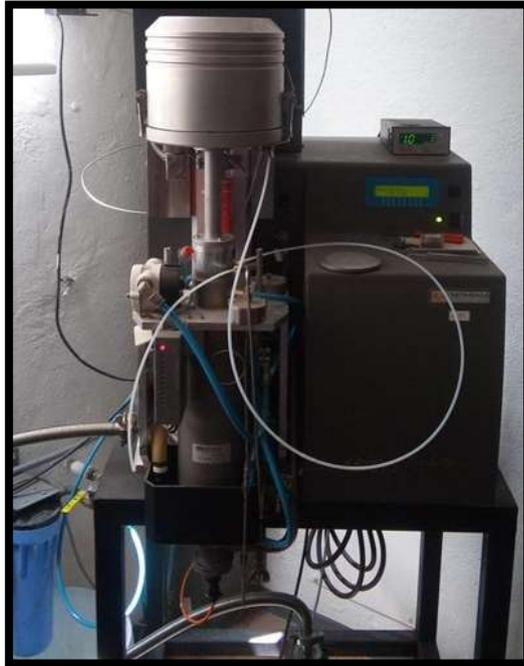
**Figura 16.** Analizador termogravimétrico
