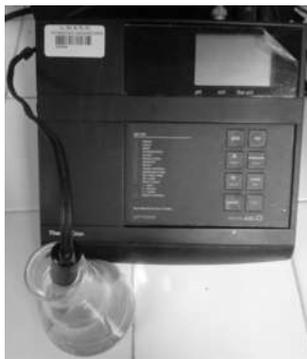
**Ilustración 3.** Potenciómetro
