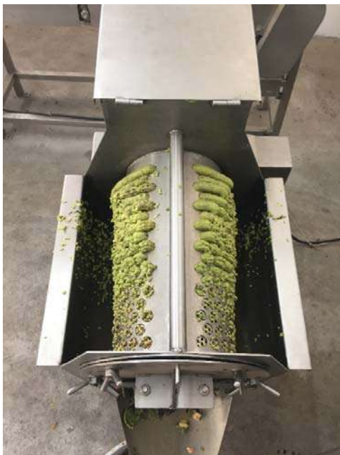
Figura 12.-Despulpador operando en condiciones de optimización.
