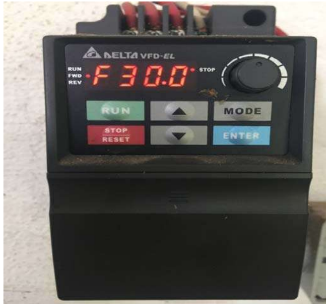
Figura 9.- Potenci3metro para regular la velocidad del despulpador (imagen propia)
