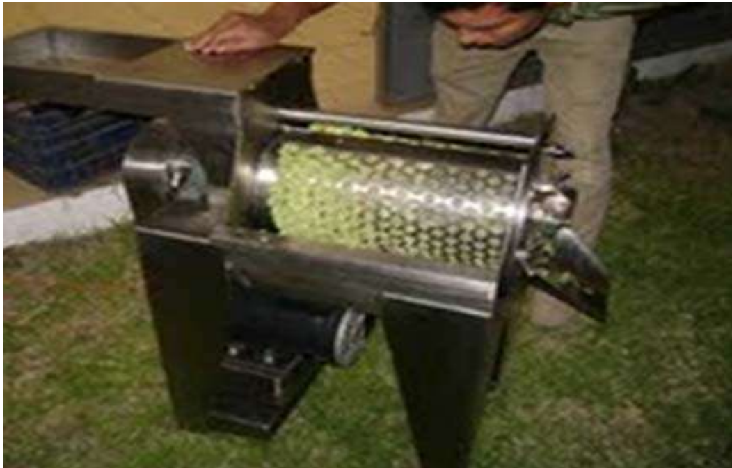
Figura 10.- Obtenci3n de la pulpa de aguacate en el despulpador
