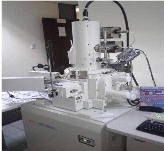
**Figura III.3.** Microscopio electrónico de barrido MEB modelo JSM-7600 JEOL Noran Instruments.
