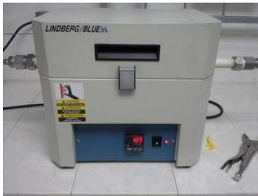
**Figura III.2.**Equipo de reducción de polvos mediante hidrógeno marca LINDBERG/BLU
