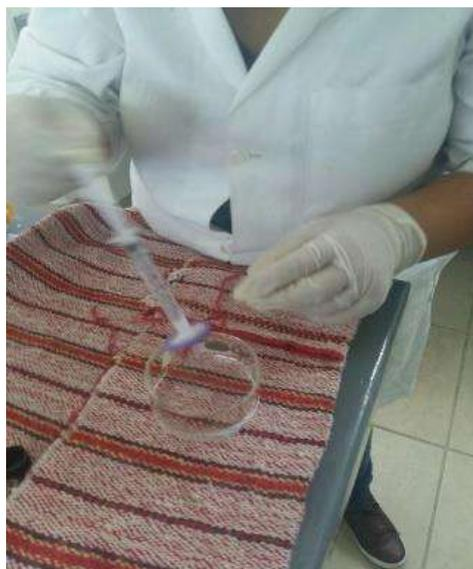
Figura 9. Filtrado de soluciones de pH.
