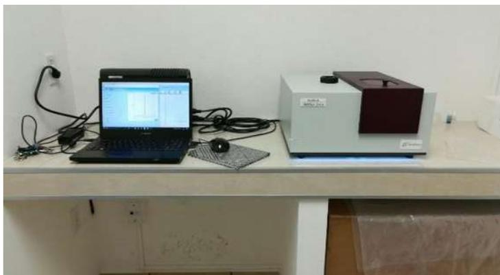
Figura 10. Equipo para medir Potencial Z, Nanobrook 90 plus Zeta.
