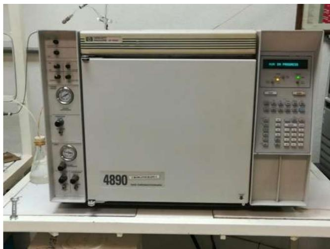
Figura 14. Cromatógrafo de gases HP 4890.
