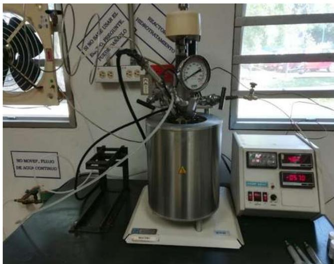
Figura 13. Reactor tipo “batch” 0.5 L de la marca Parr modelo 4842.
