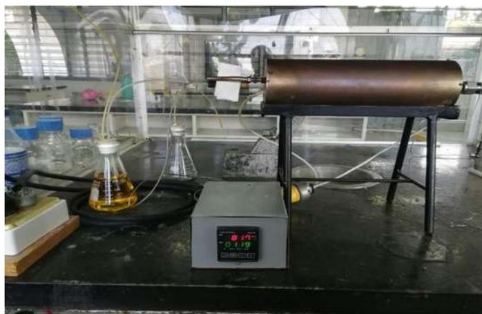
Figura 12. Horno tubular para la activación de los catalizadores.
