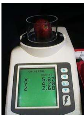
Figura 5. Colorímetro tomando la medición de la superficie de la fresa en los tres ejes.
