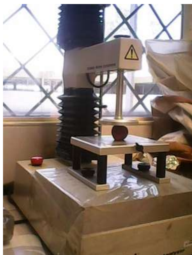
Figura 7. Texturómetro haciendo una medición de la biopelícula en la fresa.
